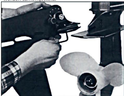
Fig. 1 Draai de stelschroeven ( C ) in de brackets. Tijdens het coaten is het schroefdraad van een beschermend laagje voorzien. Dit kan het indraaien van de stelschroeven enigszins bemoeilijken. De coating kan met een boutje of tap M8 worden verwijderd.
